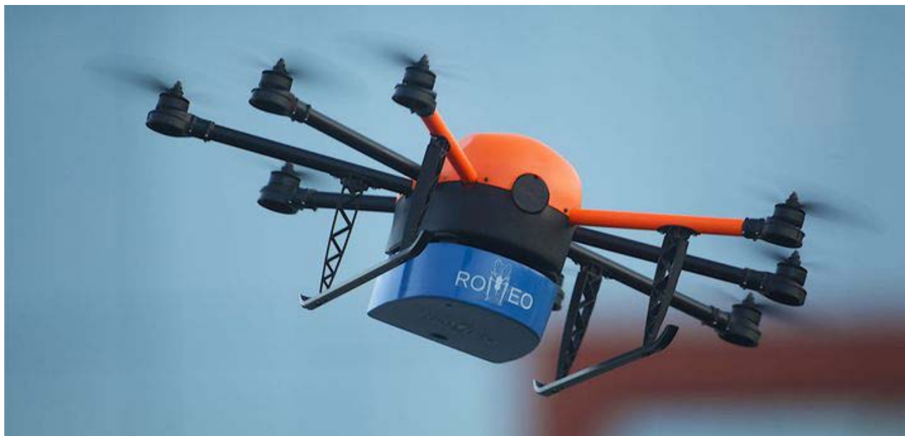
ROMEO, drone usado para a liberação de mosquitos estéreis na natureza
