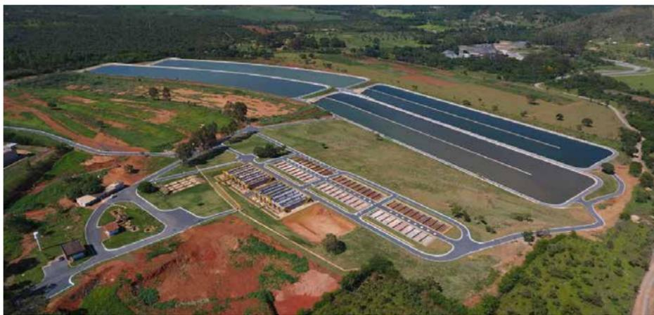
A Companhia Saneamento de Goiás S/A (Saneago) empregou R\$ 62,7 milhões para conclusão das obras de ampliação do Sistema de Esgotamento Sanitário de Planaltina: foram construídos três reatores, quatro lagoas de tratamento e uma estação elevatória de esgoto
